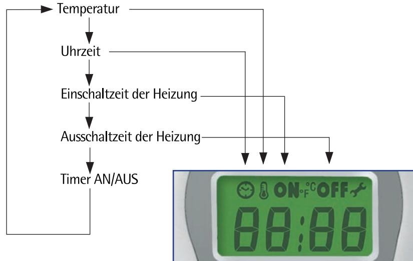
Nach dem Einsticken des Netzsteckers wird die Temperatur angezeigt.
