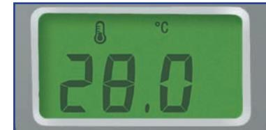
Entspricht die Temperatur des Wasserkerns der Temperatur auf dem Display, dann ist das Symbol  $^{\circ}\text{C}$  dauernd an.
